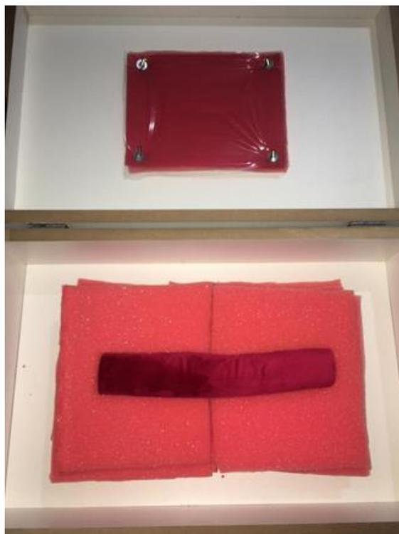
**Figura 4** – Visualização da caixa aberta. Nesta visão é possível identificar as camadas que simulam as camadas da parede abdominal, a alça confeccionada e um suporte de espuma rosa.
